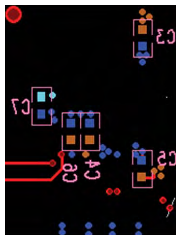
図 61. 裏面層のデカップリング
