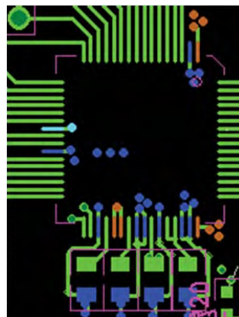
図 60. REFIN/REFOUT、REFCAPA、REFCAPB、REGCAP の各ピンに対する表面層のデカップリング
