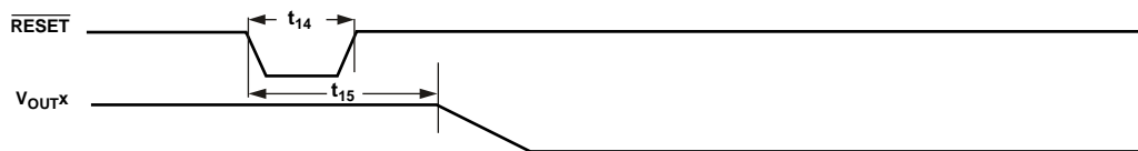
図 3. RESET タイミング図
