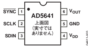
図3. 6ピンSC70のピン配置
