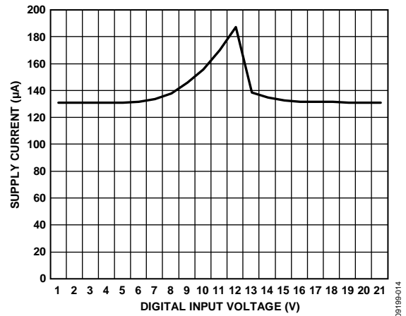
図 15. AD5512A/AD5542A 電源電流対デジタル入力電圧
