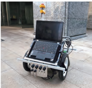
IMU「ADIS16480」を搭載したロボット「ORNE」
