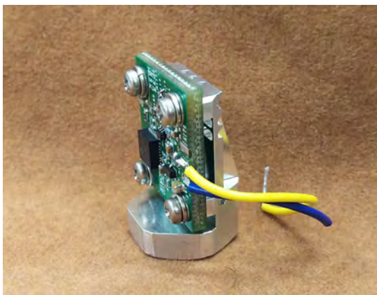
図4：デモボードを実装した実験システム アナログ・デバイスから提供されたデモボードを 振動ピックアップに取り付けて実験を行った。
