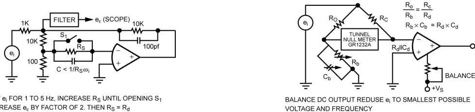
図 12. 差動インピーダンスのテスト回路
