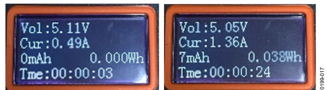
図 17. 上側 USB ポート (左写真) および DCP コントローラ付きの下側ポート (右写真) から電話 A を充電しているときの ET910 USB マルチメータ・テスタのスクリーンショット
