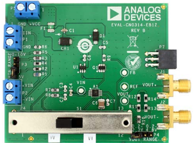
図9. EVAL-CN0314-EB1Z ボードの写真
