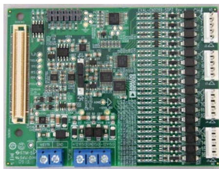
図 25. EVAL-CN0269-SDPZ 評価ボード
