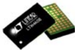
図1. LTM4608は9mm×15mm×2.8mm LGAパッケージで高い電力密度を与える
