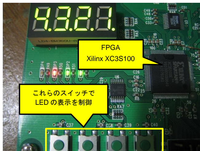
図2. スwitchのチャタリング防止 FPGA上でRTLでやってみた
