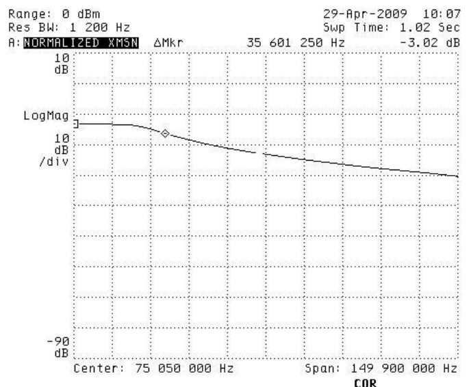
図 9. 0.45\text{V rms} の信号を入力したときの AD8021 の大振幅応答のようす
