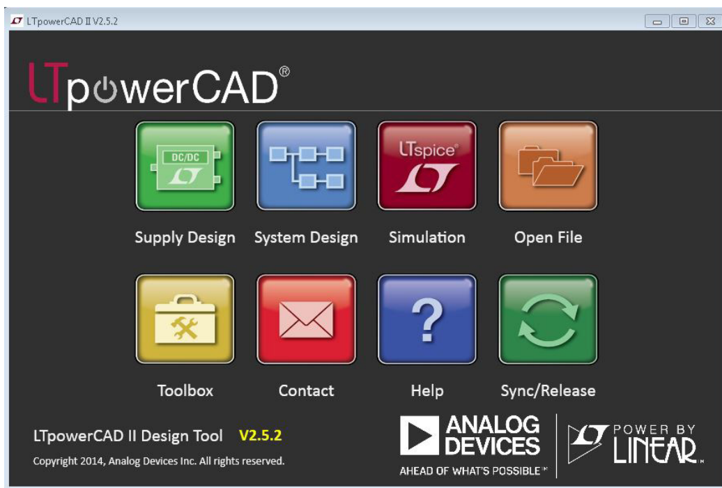
図 1. FPGA の給電に適した DC/DC コンバータを選択するためのツール「LTpowerCAD」
