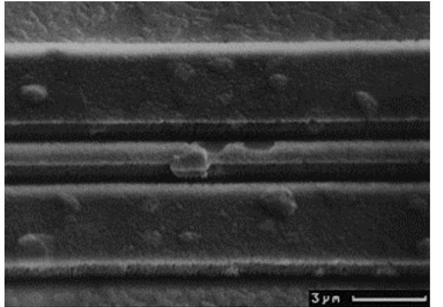
Figure 17. EM Failures
