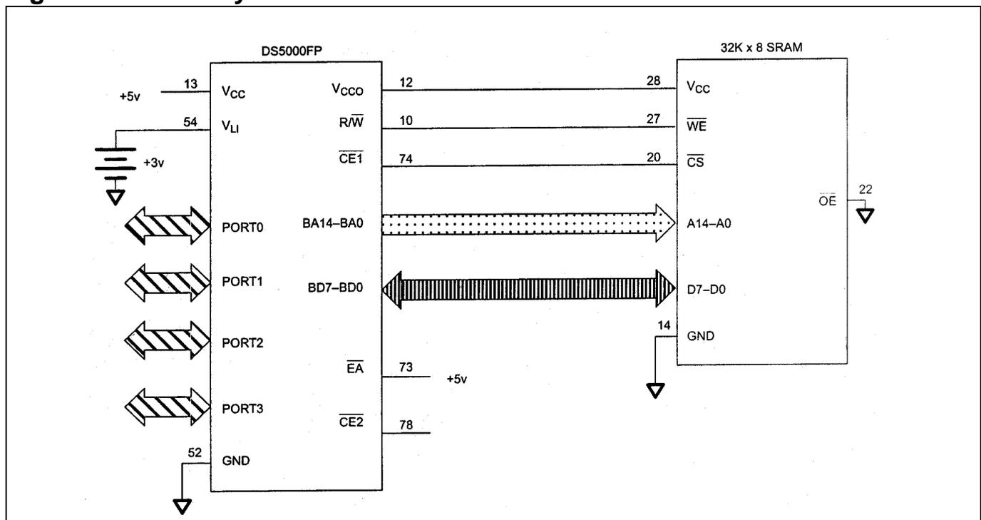
Figure 5-2. DS5000 Series Module Block Diagram
