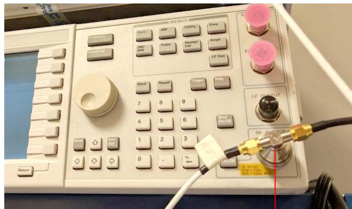
Figure 25. SMA Tee Adapter
