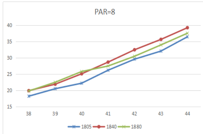
Figure 17. Efficiency vs Output Power@PAR=10dB&amp;PAR=8dB(1805、1840、1880MHz)
