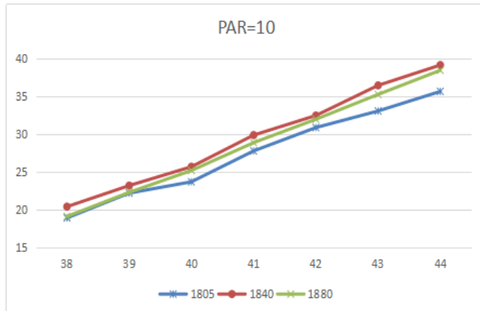
Figure 17. Efficiency vs Output Power@PAR=10dB&amp;PAR=8dB(1805、1840、1880MHz)
