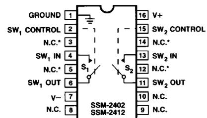
\* GUARD PINS FOR INPUT/OUTPUT ISOLATION (GROUND FOR BEST PERFORMANCE)
