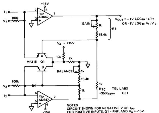
Figure 25. Log-Ratio Amplifier
