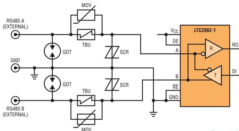
GDT: BOURNS 2031-42T-SM; 420V GAS DISCHARGE TUBE
