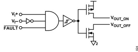
Figure 20. V<sub>1+</sub> and V<sub>1-</sub> Block Diagram
