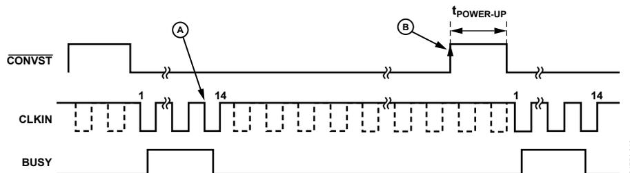
Figure 40. Autoshutdown/Autostandby Mode
