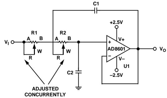
Figure 23. Sallen-Key Low-Pass Filter
