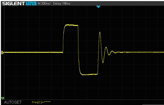
그림 6: 경부하일 때 통상적인 MAX38640A VLX 파형을 포착한 오실로스코프 화면
