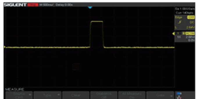
그림 12: 10mA 경부하일 때 MAX20343H HVLX 파형을 포착한 오실로스코프 화면
