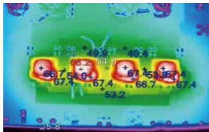
图 2：并联运行的 4 个 LTM4636 之间能精准均流，对于 160A 应用，温度仅上升 40°C。
