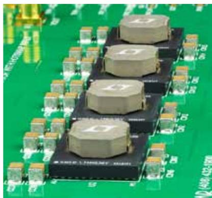
图 1：LTM4636 的 3D 封装把最热的组件之一电感器置于顶部，这里有很大的表面积暴露在气流中。通过并联 LTM4636 以增大供电功率是很容易，只需复制一个通道的布局并成倍地复制即可。这里的干净布局显示了各提供 40A 的 4 个通道。
