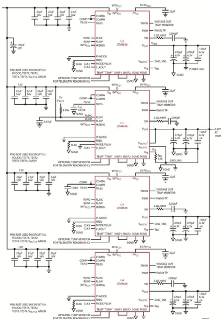
图 3：140W 稳压器具有 4 个并联运行的 LTM4636，每个都具有精准电流均分能力和高效率，从 12V 输入至 0.9V 输出（在 160A）。
