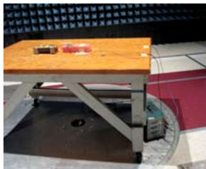
图1: 测试配置: 电源(一个实验室等级的线性电源)放置在地板上。
