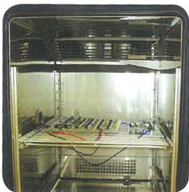
图1：在一个高低温试验箱中工作的SmartMesh节点
