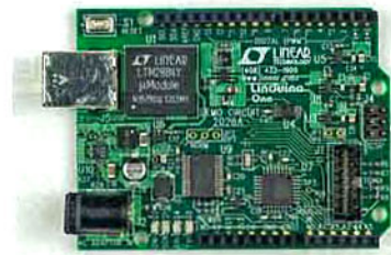
图3: Linduino One是一款Arduino Uno兼容的微控制器电路板,与USB完全隔离并直接连至LTC6811
