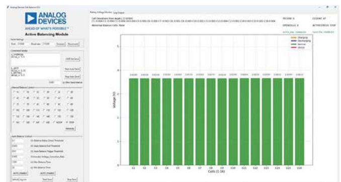
圖1. 主動均衡GUI：顯示電芯電壓、均衡狀態和錯誤警報的圖形介面。
