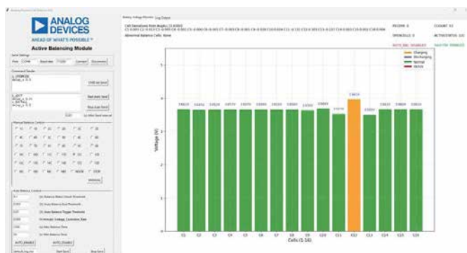
圖8. 主動均衡運行期間，為特定電芯充電時對電壓測量的影響。
