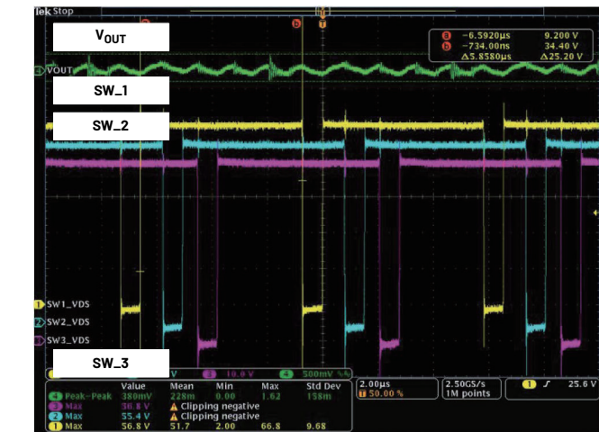
图8. 以44 V输入和63.2 A输出负载运行时，放电工作模式期间主控制器和扩展器的开关波形。
