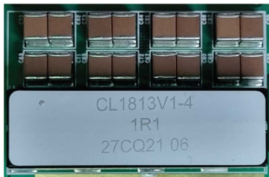
图9. 单通道四相耦合电感，与四相混合转换器配合使用时，可实现48 V至6 V转换。
