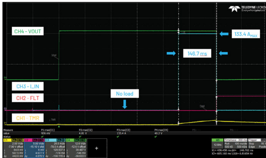
圖4. 限流保護，輸入電壓40 V，負載電流0 A至130 A。
