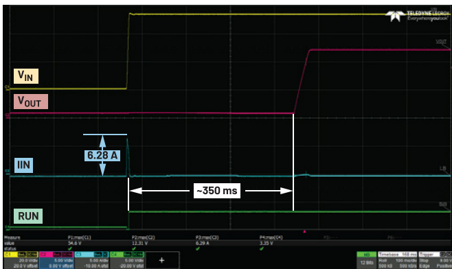
圖6. 1/4磚電源在空載條件下啟動。
