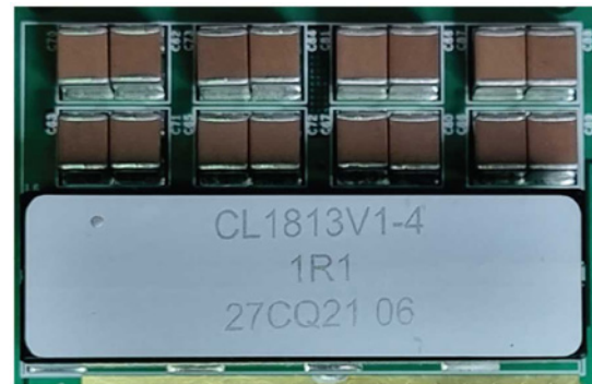
圖9. 單通道四相耦合電感，與四相混合轉換器配合使用時，可實現48 V至6 V轉換。
