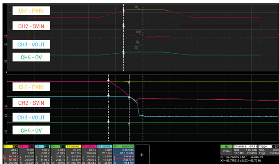
圖8.64 V輸入電壓時觸發過壓保護(OVP)。
