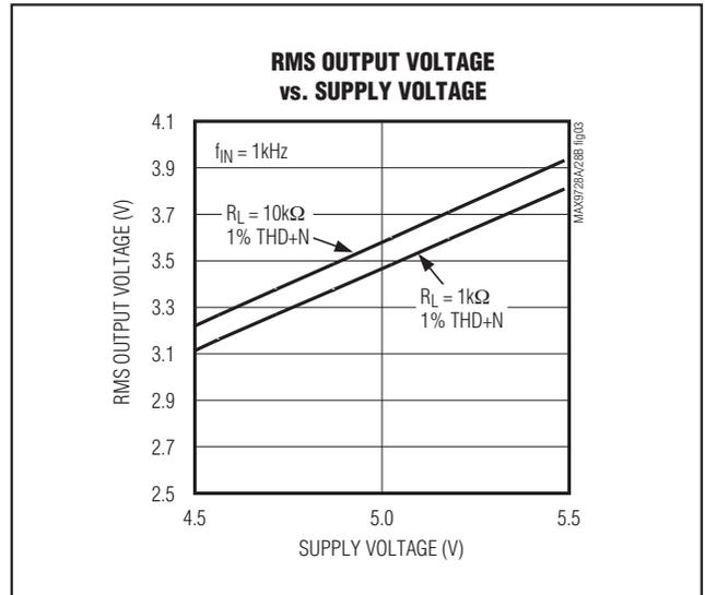
图3. RMS输出电压与电源电压的关系
