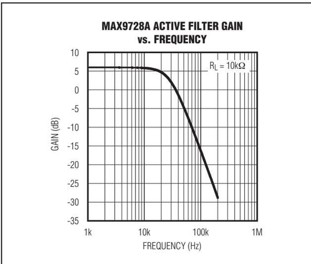
图5. 图4中有源滤波器的频率响应
