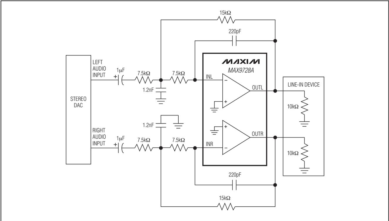
图4. MAX9728A线出放大器和滤波电路配置
