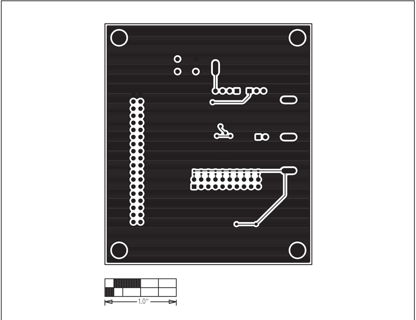
图5. MAX6966评估板PCB布局—焊接层
