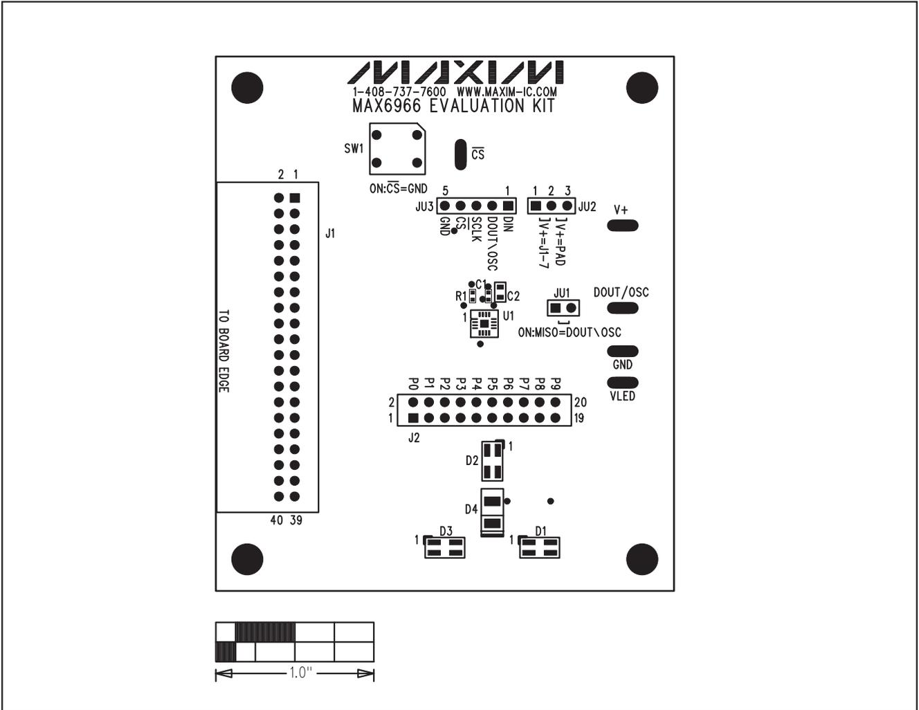
图3. MAX6966 评估板元件布局—元件层
