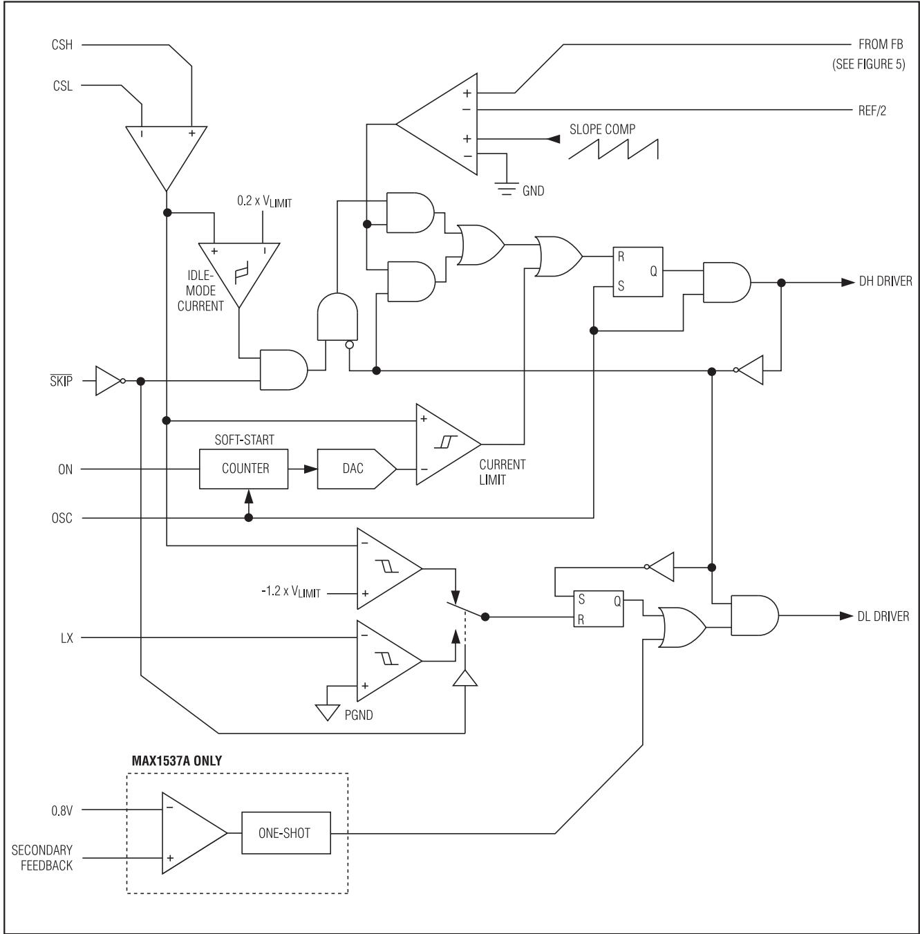
图3. PWM控制器功能框图
