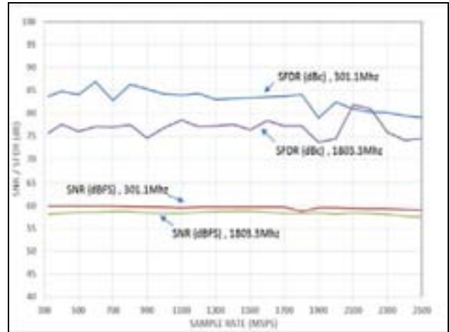
图14. SNR/SFDR与采样速率的关系
