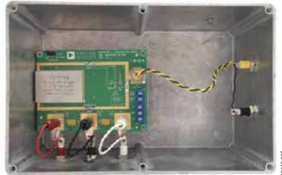
图6. 内含ADA4530-1R-EBZ-BUF的金属盒(连接到信号地)
