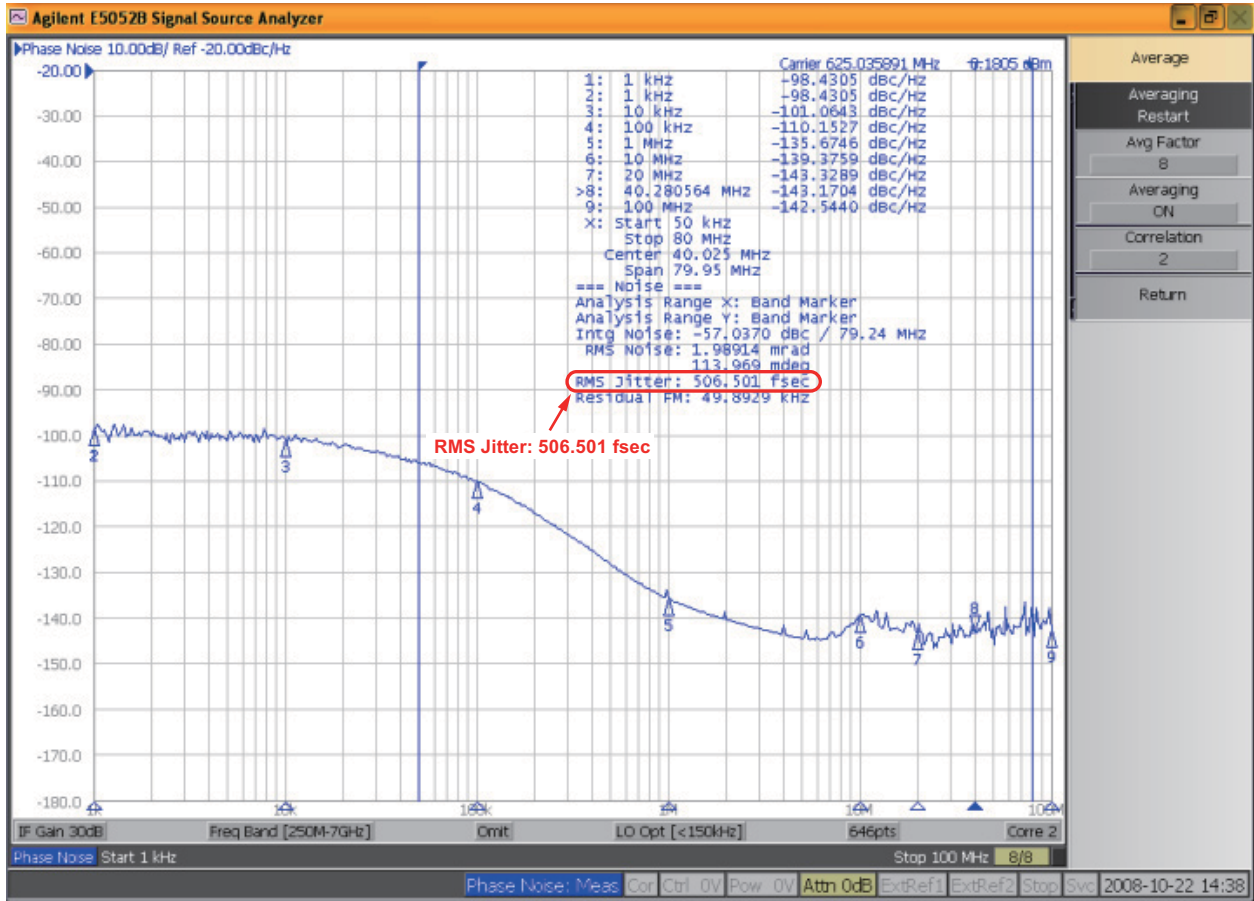
图5. AD9552相位噪声，不包含杂散噪声
