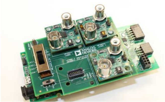
图2. AD594x水质测量系统 (CN0428)
