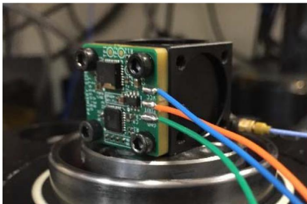
图3. 利用EVAL-XLMOUNT1将EVAL-CN0533-EBZ安装到振动台上
