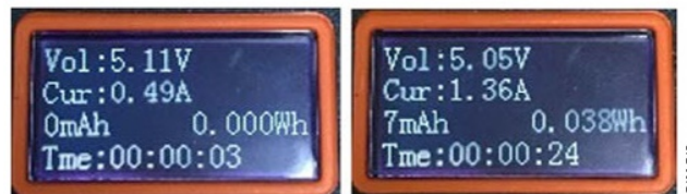
图17. ET910 USB万用表测试仪屏幕截图，左边是电话A从上方USB端口充电，右边是从含有DCP控制器的下方端口充电
