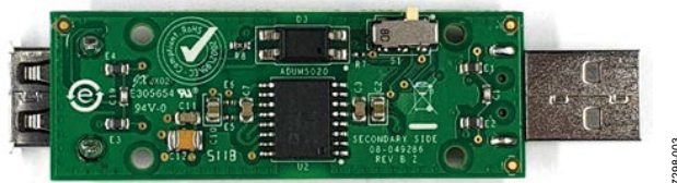
图 3. 全速操作模式对应的 S1 开关位置
