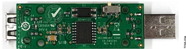
图 4. 低速操作模式对应的 S1 开关位置
