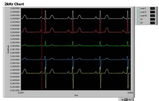
图 3. 连接病人仿真器的 ADAS1000 屏幕截图，心率 = 70 BPM
