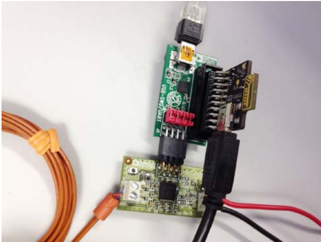
图3. 连接至USB-SWD/UART板和SEGGER J-Link-Lite板的 EVAL-CN0300-EB1Z板
