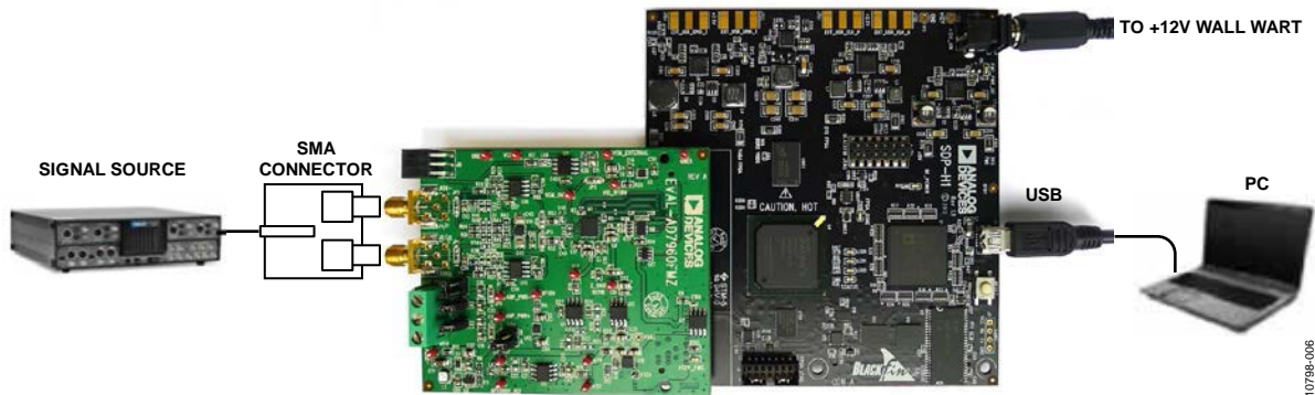
图6. EVAL-AD7960FMCZ板连接EVAL-SDP-CH1Z板
