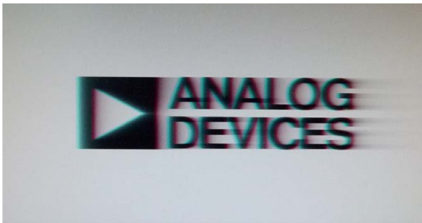
图7. 未对通过300米Cat-5e电缆传输的图像应用均衡和偏斜校正时
