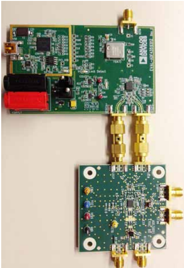
图7. 用于连接ADF4351和ADL5801的电路板设置
