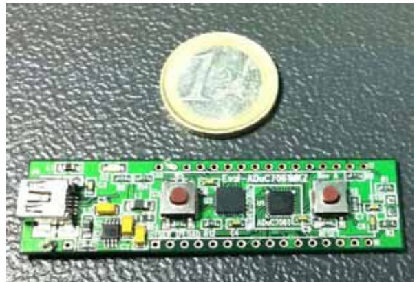
图2. 本电路所用的EVAL-ADUC7061MKZ板
