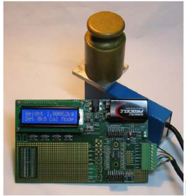
图2.采用AD7195 的电子秤系统设置
