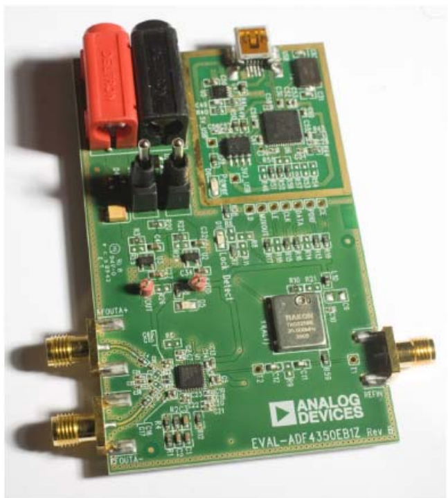
图2. 采用低噪声调节器ADP150的评估板EVAL-ADF4350EB1Z B版
